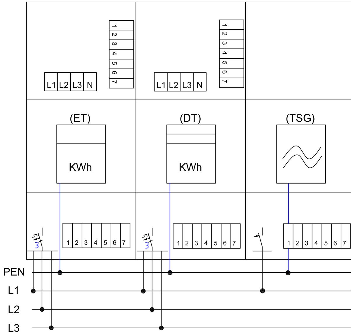
**Klemmleiste 7-polig / oberer Anschlußraum**
